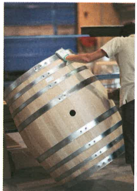
Après le cintrage, pour maintenir les douelles assemblées, on les cercle de bois souple ou de métal, parfois les deux.
