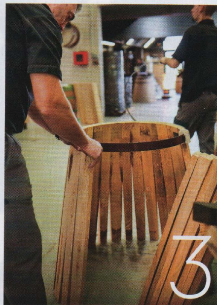
Le cintrage des douelles et la pause des cercles de fer à coups de marteau. Suivront l'écourtage et le dollage.
