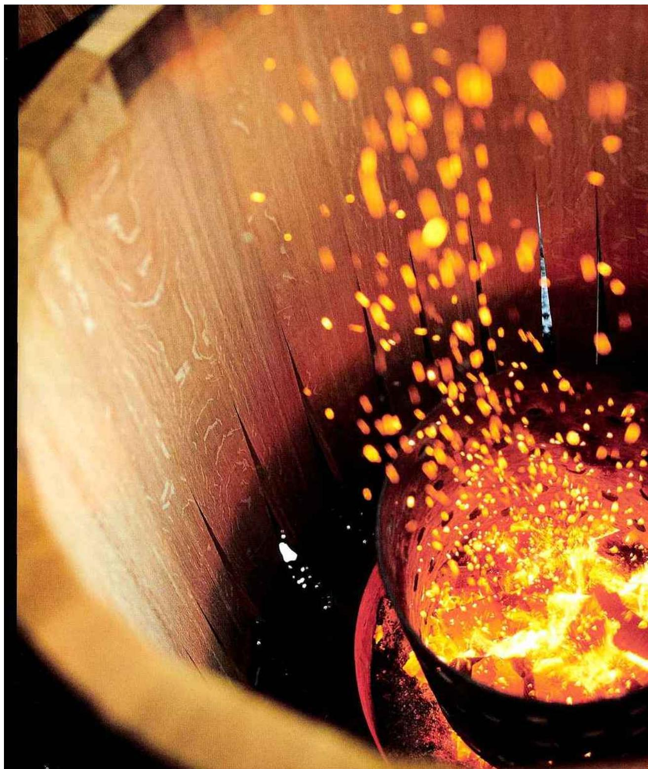
Le « bousinage » est l'opération de chauffe de l'intérieur de la barrique qui va modifier la composition physico-chimique pour délivrer des tannins et des arômes au contact du vin. Il existe plusieurs types de chauffe
