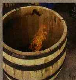
Des secrets de fabrication qui font toute la différence. Ici, le chauffage. © C. STEFAN
